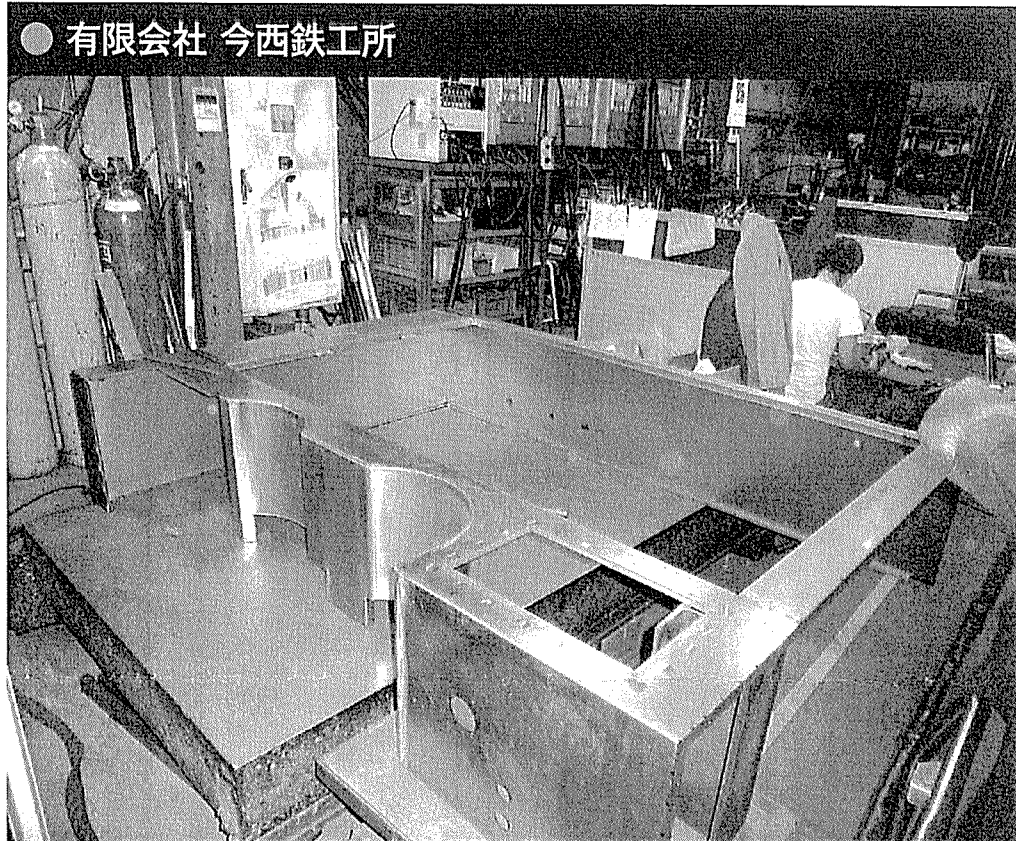
● 有限会社 今西鉄工所 設備装置用の制御盤。装置の構造上側面に装置の一部が食い込むような形状を採用した盤筐体
